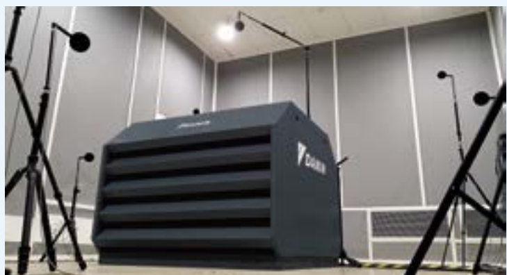
Pomiar poziomu mocy akustycznej w komorze akustycznej
