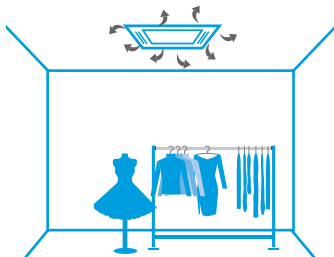
Rozkład powietrza z zabrudzonym filtrem
