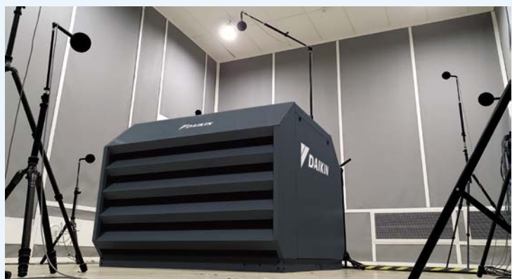
Pomiar poziomu mocy akustycznej w komorze akustycznej
